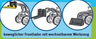
beweglicher Frontlader mit wechselbarem Werkzeug
